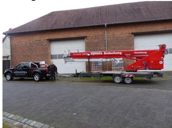
Unser Anhäng-Kran AHK 30/1600 überzeugt vor allem durch seine enorme Leistung. 1,6 Tonnen maximale Nutzlast sind in dieser Klasse ein Spitzenwert und mit einer Ausfahrlänge von 30 Meter lässt dieses Gerät keine Wünsche offen.
